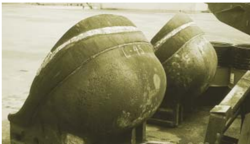
Многокофова драга. Съединяване на нов режещ ръб с ОК 68.82.
