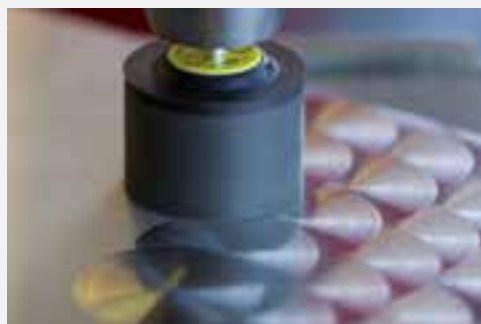
Пример за декоративно шлайфане с R-Flex точки за шарки SFM 656 върху ламарина от неръждаема стомана
