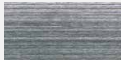
Абразивен моп зърно 40 дълга непрекъсната линейна структура, минимум вдлъбвания, гладка окончателна обработка
