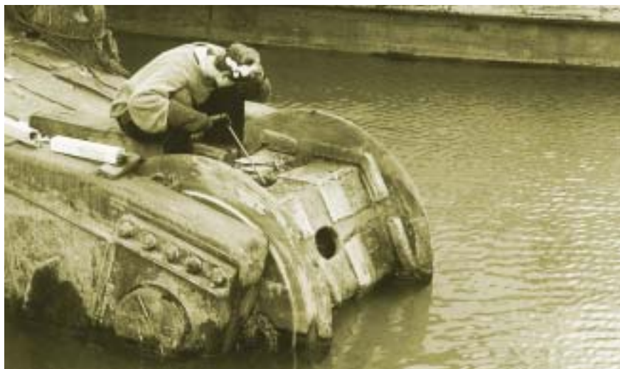
Наваряване на въртящ се барабан. Изграждане с ОК 83.28
