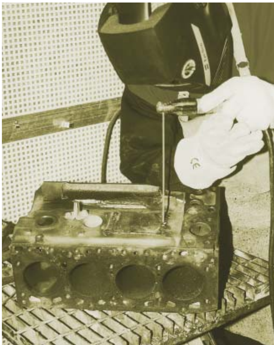
Двигателен блок. Ремонт на чугунена отливка с ОК 92.18 и ОК 92.60
