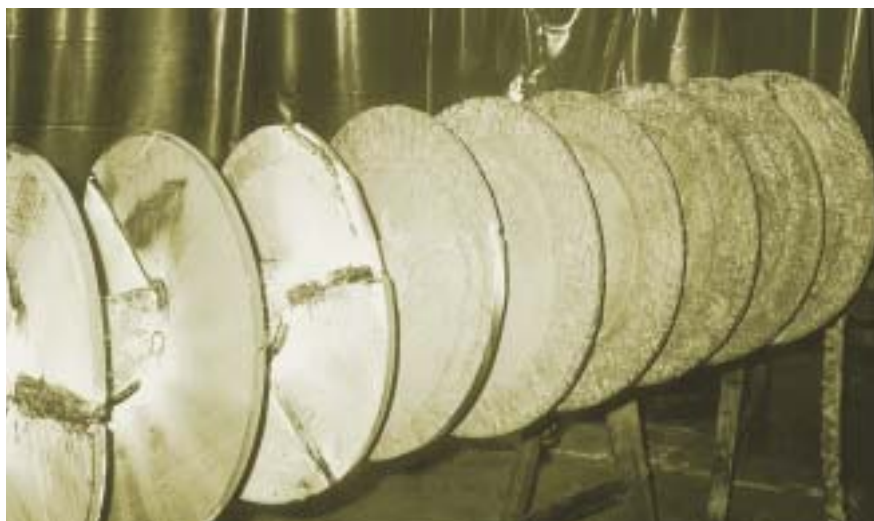
Питателен винт: Наваряване с ОК Tubrodur 14.70.
