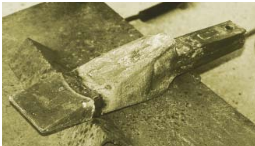
Ремонт на върха на зъб от багерна кофа с ОК 67.45 или ОК Tubrodur 14.71.
