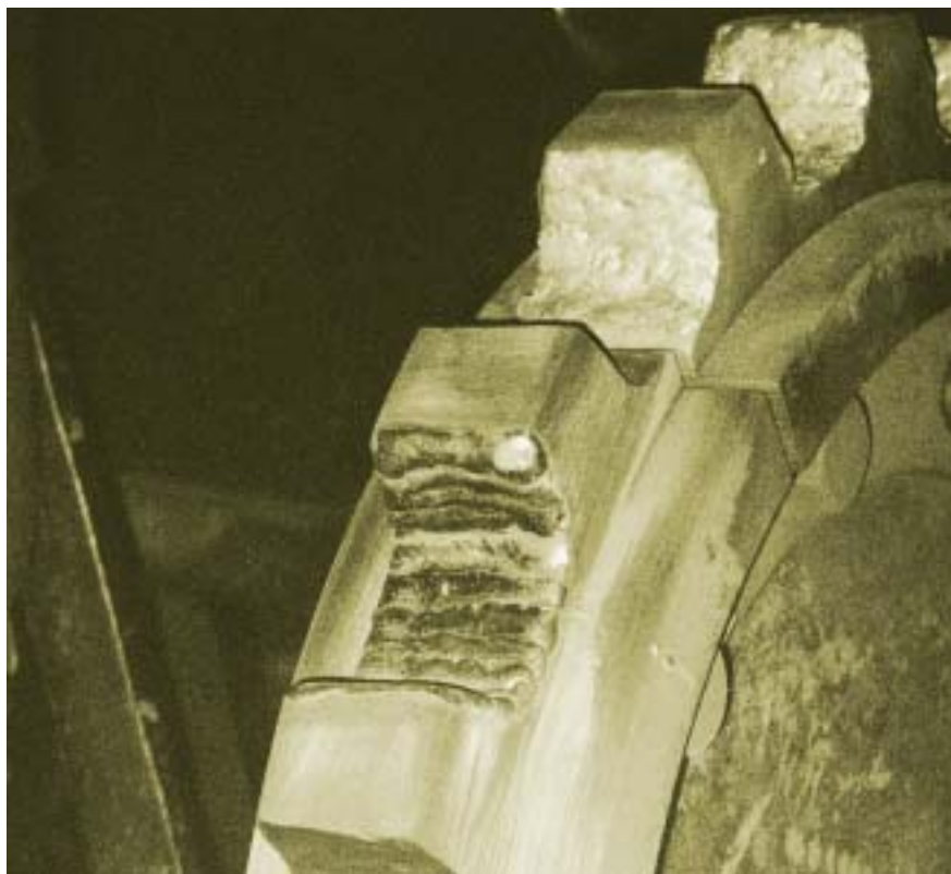
Задвижващо зъбно колело: превантивно наваряване с ОК 83.28.
